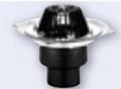
**HL64.1B** кровельная воронка с горизонтальным выпуском для эксплуатируемой кровли, электроподогревом U=230В, мощность 10-30Вт, с теплоизоляцией, с фланцем из нержавеющей стали для обжима гидроизоляции и трапом, DN75/ DN110.
