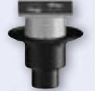
**HL310NPr** ПП/ПЕ трап как HL310N с сифоном "Primus" (с добавочным запахозапирающим устройством, вступающим в действие на фазе высыхания). То есть, при высыхании водяного затвора нет необходимости доливать воду в трап.
