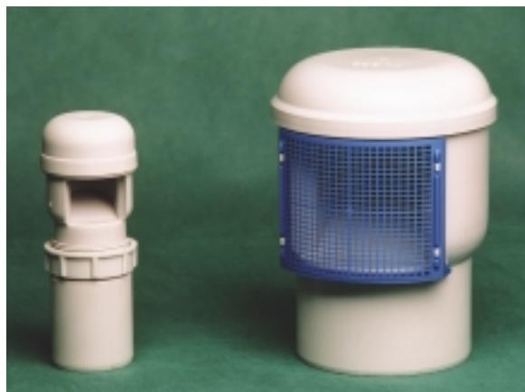
канализацию воду с температурой 90 °С, поэтому сифоны из ПВХ применять нельзя (для сифонов из ПВХ температура воды не должна превышать 65 °С). Компания HL все сифоны выпускает из ПП и во всех сифонах с возможностью подключения стиральной машины применяет струйные обратные клапаны.
