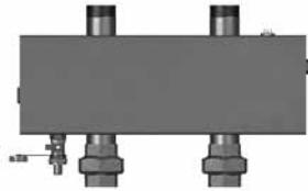
Подходит для монтажа на распределителях Майбес до 125 кВт. Межосевое расстояние подключений 200 мм. Возможен монтаж в вертикальном и горизонтальном положении.
