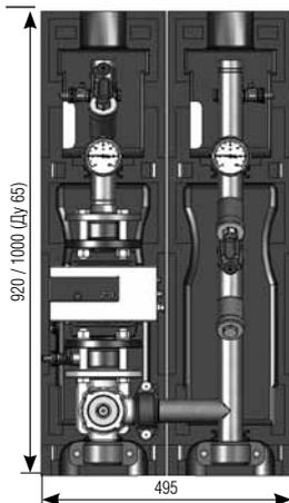
**В Насосная группа FL-МК (под фланцевый насос, контур с трехходовым смесителем для монтажа на напольных распределителях Майбес)**
