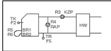
Функциональная схема 2 (KZR) с 2-х ступенчатой горелкой, насосом котлового контура (схема с гидравлической стрелкой) и дополнительной защитой котла от низкотемпературной коррозии (насос подмеса).
