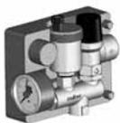
В изделие входят: предохранительный клапан 1/2" x 3/4", 3 бар, манометр, автоматический воздухоотводчик, негорючая термоизоляция. Подключение 1/2" ВР. Для котлов до 50 кВт.
