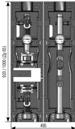
**В Насосная группа FL-UK (фланцевый насос, контур без смешения, для монтажа на напольных распределителях Майбес)**
