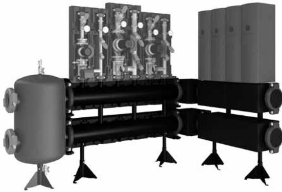
черным лаком, поставляются в термоизоляции, с двумя напольными опорами. Распределитель с одной стороны имеет глухие диски в соединениях Victaulic в верхнем и нижнем коллекторах. При этом каждый из дисков имеет заглушку 1/2", в которую, например, может быть интегрирован кран KFE для слива коллекторов. Для пристыковки другого распределителя при расширении количества контуров потребителей, глухие диски вынимаются и соединение осуществляется при помощи освободившихся обжимных муфт Victaulic
