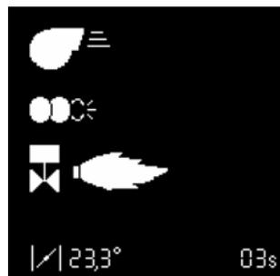
Блок управления ожидает разрешения на регулирование работы котла.
