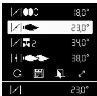
Когда пламя обнаружено и стабилизировалось, горелка устанавливается на работу на 1-ой ступени по истечении времени безопасности.
