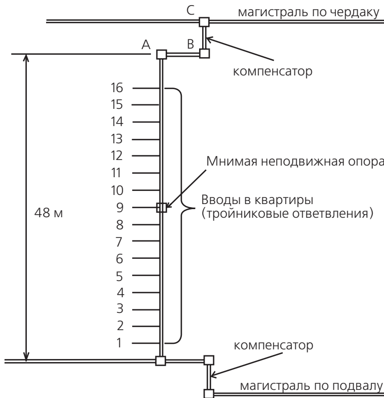
Рис.3.7. 16-ти этажный стояк горячего водоснабжения.
