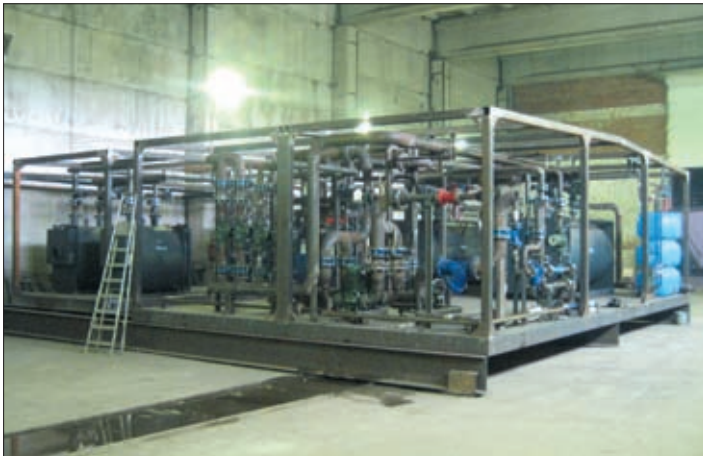
Изготовление блочно-модульных котельных на производственной базе
