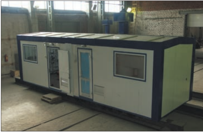
Блок-модуль котельной на участке сборки
