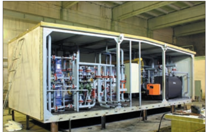
Изготовление блочно-модульных котельных на производственной базе
