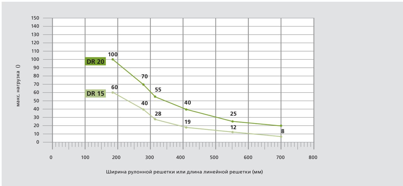
Максимальные коэффициенты нагрузки действительны для различных длин отдельных прутков в решеточном соединении, нагружаемых расположенной по центру статической точечной нагрузкой. Решеточное соединение опирается исключительно на края - точки опоры каждая приблизительно по 8 мм.
