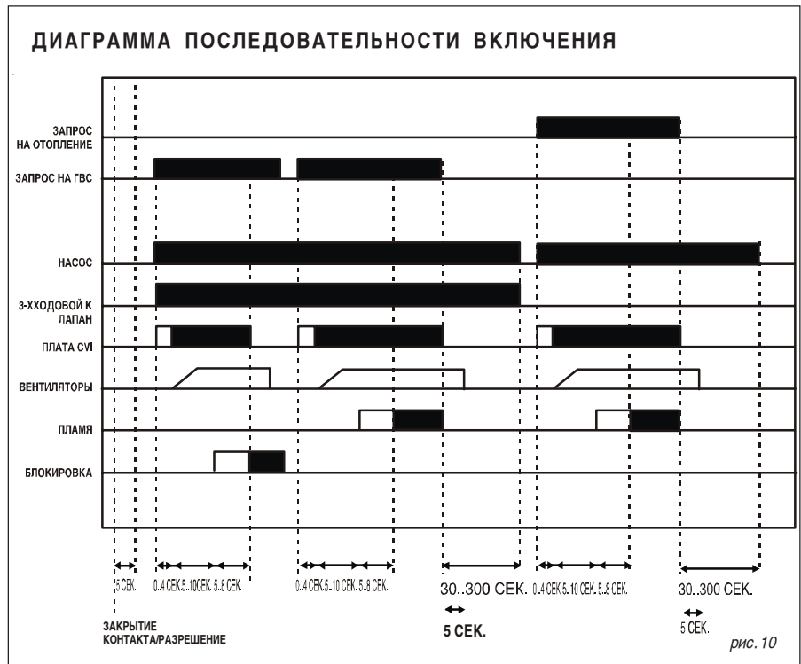
Диаграмма включения котла Modulex, состоящего из 7 горелок с 6 работающими модулями и одним в процессе включения. Размещение электронных модулей контроля мощности котла.
