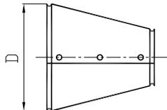
Отверстия Ø 3,2 мм под саморезы в количестве, зависящем от диаметра.
