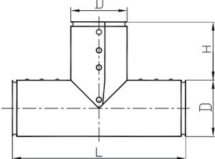
Отверстия Ø 3,2 мм под саморезы в количестве, зависящем от диаметра тройника.
