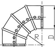
2 отверстия  $\varnothing 3,2$  мм в каждом сегменте под саморезы.
